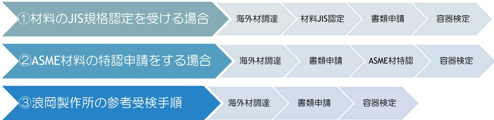
※弊社は、主要な市中流通材(海外ASME規格)による、圧力容器の製造許可を受けています。そのため、海外材料をそのまま使用できます。
